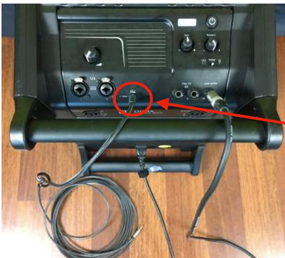
5.3: Mini - Klinkenkabel in nur „eine“ Tonanlage stecken
